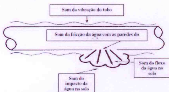
Figura 1 – Representação esquemática dos sons gerados por um vazamento (Sapporo/Japão, 1994).
