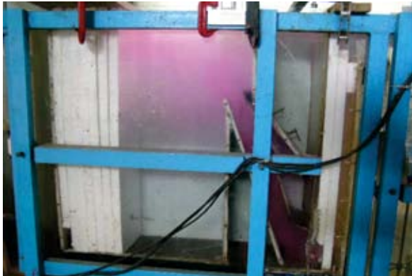
Figura 10 - Algumas das imagens dos ensaios com uso de traçador que envolveram a definição das condições de coleta da água flotada na unidade, operando com modo convencional. Taxa de 200 \text{ m}^3 \cdot \text{m}^2 \cdot \text{d}^{-1} , p=0,10 , Td_{zc} = 40\text{s} e a saída da água flotada feita placa com orifícios (dispositivo Tipo 2) localizada na porção inferior da zona de separação.
