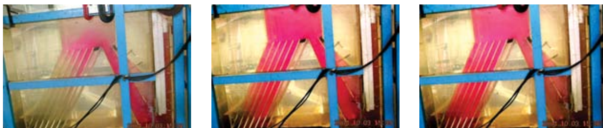
Figura 7 - Algumas das imagens dos ensaios com uso de traçadores, mostrando a distribuição do escoamento de líquido entre as lamelas em três momentos subsequentes da unidade, operando no modo de alta taxa. Taxa de aplicação superficial no flotor de 460 \text{ m}^3 \cdot \text{m}^2 \cdot \text{d}^{-1} e a saída da água flotada p=0,05 , Td_{zc}=40 s e a saída de água flotada feita através de placa com orifícios localizada logo abaixo do conjunto de lamelas (dispositivo Tipo 2).
