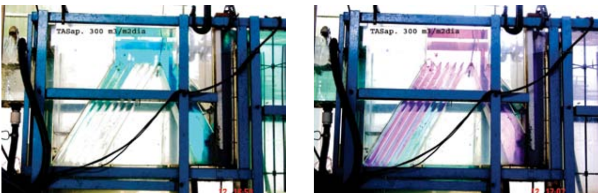
Figura 5 - Algumas das imagens dos ensaios com uso de traçadores mostrando a distribuição do escoamento de líquido entre as lamelas em dois momentos subsequentes da unidade operando no modo de alta taxa. Taxa de 300 \text{ m}^3/\text{m}^2 \cdot \text{d}^1 , p=0,1 e td_{zc}=90 e a saída feita através de tubulação perfurada localizada na parte superior da zona de saída da piloto (dispositivo Tipo 1).
