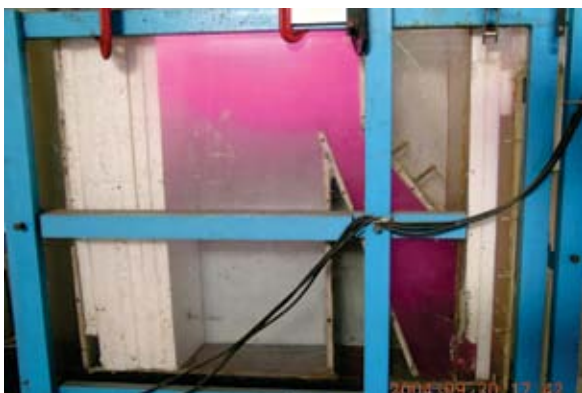
Figura 11- Algumas das imagens dos ensaios de traçador que envolveram a definição das condições de coleta da água flotada na unidade, operando no modo convencional. Taxa de 200 \text{ m}^3 \cdot \text{m}^2 \cdot \text{d}^{-1} , p=0,10 , Td_{zc} = 90\text{s} e a saída da água flotada feita através de placa com orifícios (dispositivo Tipo 2) localizada na porção inferior da zona de separação.
