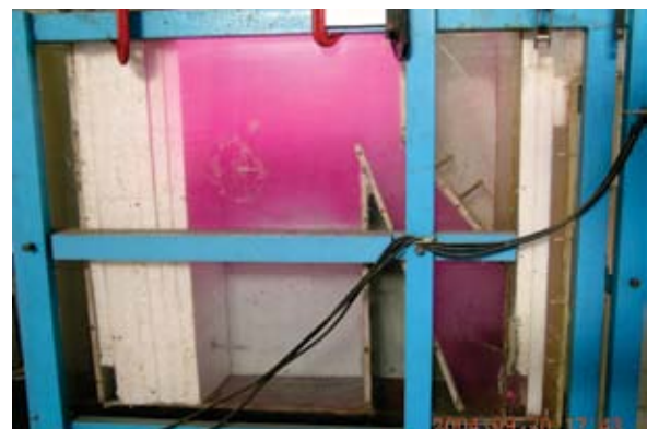
Figura 11- Algumas das imagens dos ensaios de traçador que envolveram a definição das condições de coleta da água flotada na unidade, operando no modo convencional. Taxa de 200 \text{ m}^3 \cdot \text{m}^2 \cdot \text{d}^{-1} , p=0,10 , Td_{zc} = 90\text{s} e a saída da água flotada feita através de placa com orifícios (dispositivo Tipo 2) localizada na porção inferior da zona de separação.
