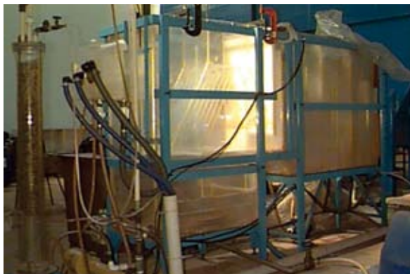
Figura 1 – Fotografia da instalação piloto de flotação por ar dissolvido com módulo de alta taxa instalado em seu interior.
