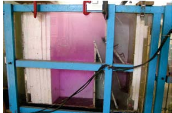
Figura 10 - Algumas das imagens dos ensaios com uso de traçador que envolveram a definição das condições de coleta da água flotada na unidade, operando com modo convencional. Taxa de 200 \text{ m}^3 \cdot \text{m}^2 \cdot \text{d}^{-1} , p=0,10 , Td_{zc} = 40\text{s} e a saída da água flotada feita placa com orifícios (dispositivo Tipo 2) localizada na porção inferior da zona de separação.
