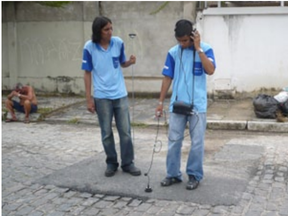
Figura 2 – Utilização do geofone eletrônico para pesquisa acústica
