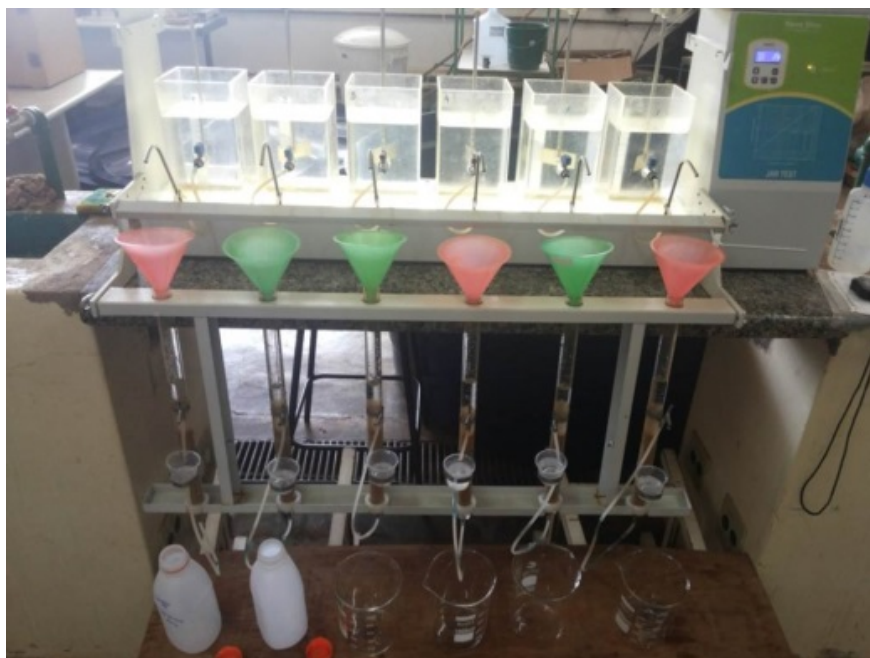
Figura 1 – Reator estático do tipo jar teste acoplado aos filtros de laboratório com areia.
