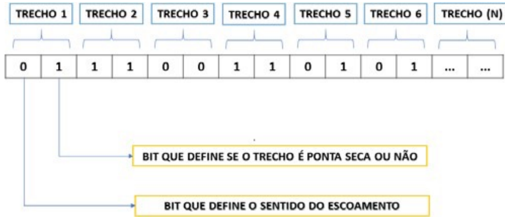
Figura 2 - Representação binária da posição de uma partícula dentro do método PSO. Fonte: Rodrigues et al. (2020)
