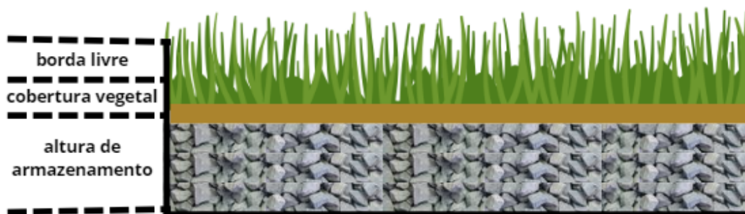
Figura 3 – Esquema hipotético de uma trincheira de infiltração com as camadas que a compõe.
