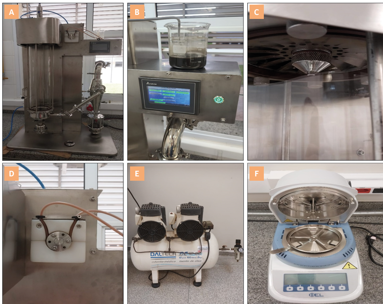
Figura 1 – (a) Spray-dryer ( 0,5 \text{ L/h} ) com detalhe do ciclone e receptor do pó final; (b) Controlador lógico programável (CLP); (c) Bico atomizador pneumático ( orifício = 1,2 \text{ mm} ); (d) Bomba peristáltica (alimentação de produto úmido no bico atomizador); (e) Compressor de ar de 170 \text{ L min}^{-1} e válvula reguladora de pressão do bico atomizador; e (f) Balança de umidade (marca BEL).
