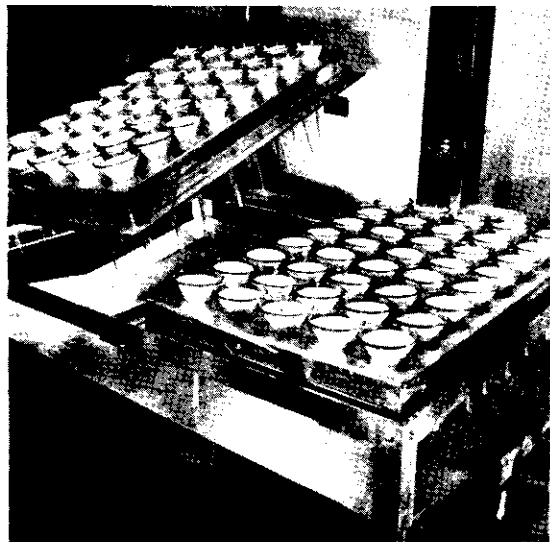
FOTO N.º 4 — Carrinho próprio para preparar papéis de filtros, com duas bandejas com capacidade de 40 funis.
