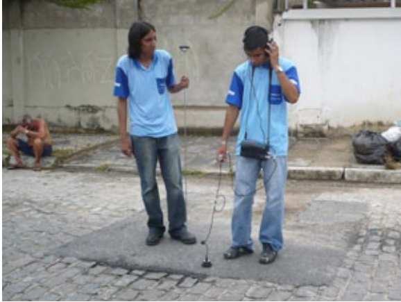
Figura 2 – Utilização do geofone eletrônico para pesquisa acústica
