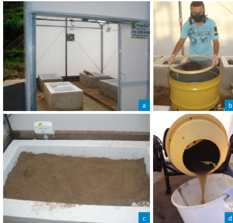
Figura 2 – Etapas da limpeza e secagem do material sedimentável: (a) unidade experimental; (b) peneiramento; (c) secagem; (d) lavagem.
