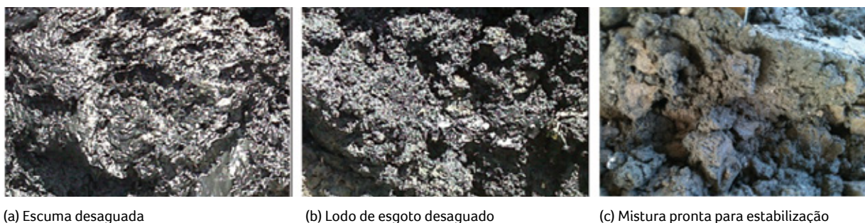
Figura 2 – Espuma e lodo desaguados antes do processo de mistura e mistura pronta para estabilização, após adição de cal virgem.
