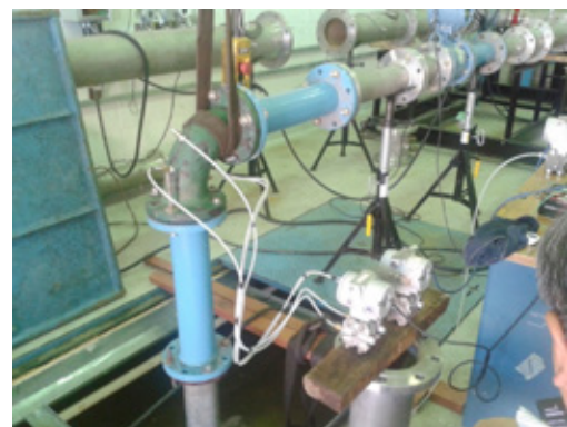
Figura 2. Arranjo experimental no Laboratório de Fluidodinâmica do IPT. A bomba submersa recalca água para a tubulação vertical, passa pelo cotovelo (com duas tomadas de pressão) e segue na horizontal, passando pelo medidor de vazão eletromagnético.
