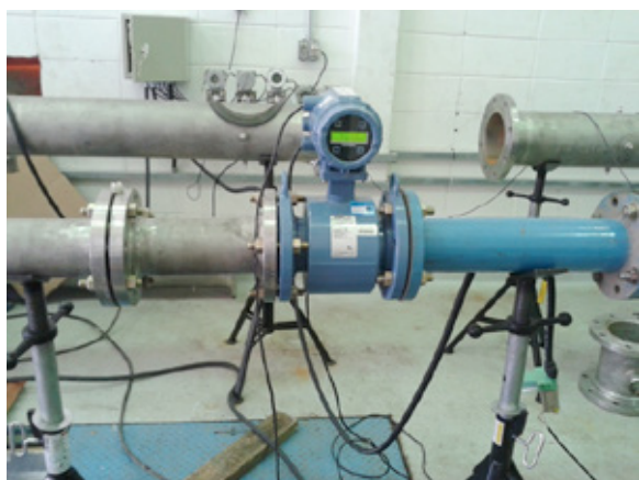
Figura 4. Medidor de vazão de referência eletromagnético e transdutores de pressão capacitivos.
