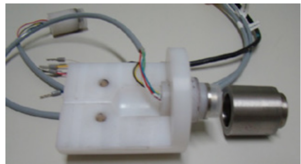
Figura 9 – Sensor OEM, como recebido da fábrica e montagem experimental para instalação em campo.
