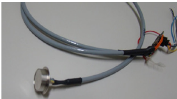
Figura 9 – Sensor OEM, como recebido da fábrica e montagem experimental para instalação em campo.
