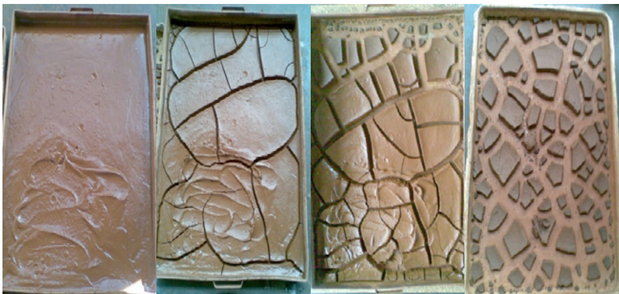
Figura 2 – Transformação do lodo de ETA do estado líquido para sólido
