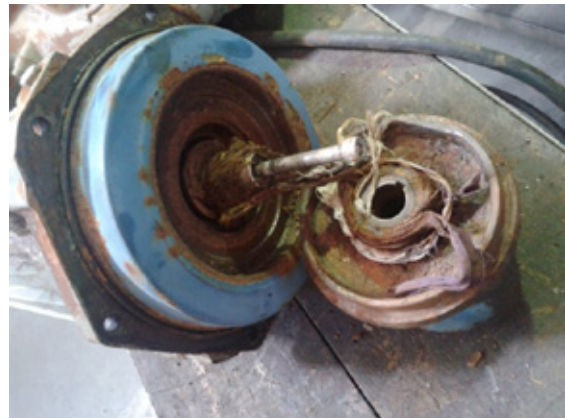
Figura 19. Foto da entrada do rotor e foto do rotor desmontado, onde podem ser vistas cordas e trapos envolvendo o rotor e que podem ocasionar picos de consumo devido a travamentos parciais do rotor.
