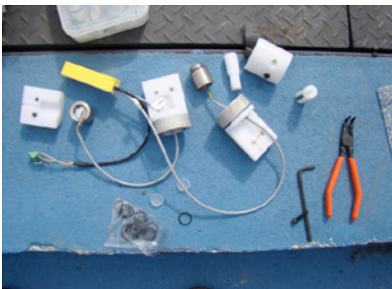
Figura 11 – A foto da esquerda mostra os sensores OEM desmontados e os dispositivos construídos para seu isolamento. Os sensores e a caixa de ligação (amarela) já estavam aparentemente isolados com silicone. A figura da esquerda mostra a caixa com o sistema de datalogger e baterias, encarregados da aquisição de sinais, colocada no gabinete elétrico das bombas.
