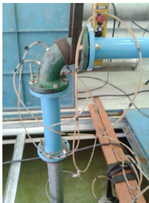
Figura 3. A foto da esquerda mostra a posição da bomba. A foto da direita mostra o cotovelo com as tomadas de pressão a 22,5° e a 45°.
