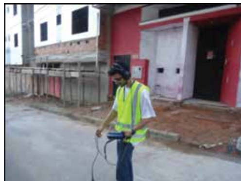
Figura 2 - Operador utilizando geofone eletrônico e data-logger de ruídos
