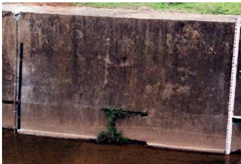
Figura 4 – Posto fluviométrico do córrego da Cachoeira. Sentido do escoamento da direita para a esquerda da figura. À direita, régua limnimétrica. À esquerda, limnógrafo.
