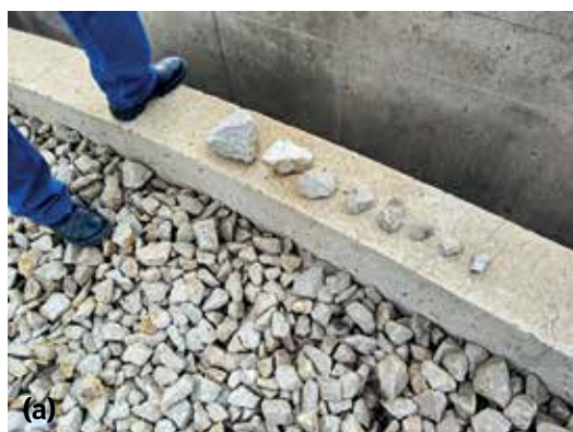
Figura 7 - (a-b) Fornecimento de pedra britada em desacordo com especificações de projeto, incluindo a presença de materiais finos na composição do material de enchimento.
