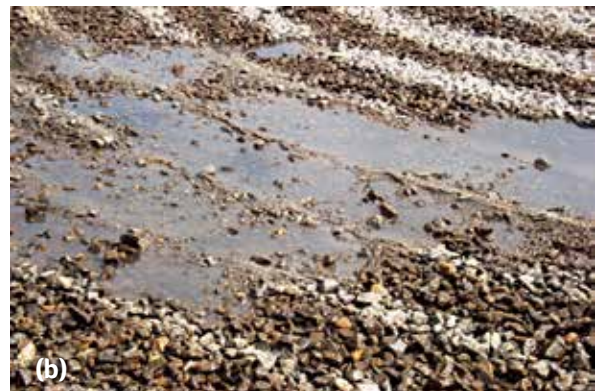
Figura 5 – a) Má distribuição do efluente no topo de filtro biológico percolador pós-reatores UASB; b) colmatação do leito de pedras por elevação da carga de sólidos.
