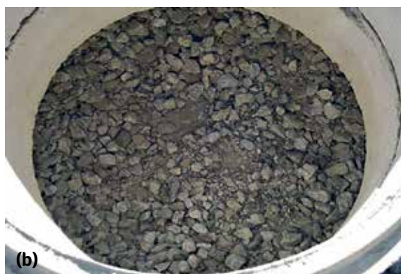
Figura 7 - (a-b) Fornecimento de pedra britada em desacordo com especificações de projeto, incluindo a presença de materiais finos na composição do material de enchimento.
