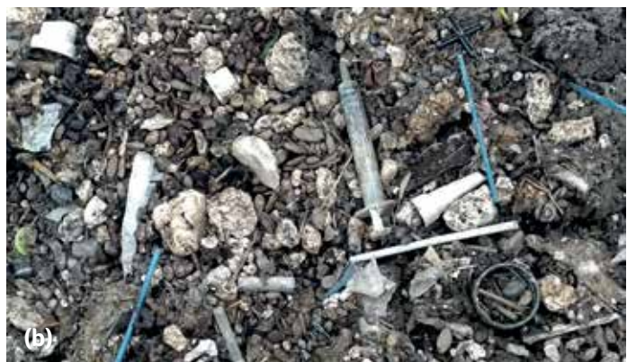
Figura 5 – a) Detritos retidos em uma unidade de peneiramento de 6 mm; b) Presença de detritos em lodo e espuma desaguados em leitos de secagem.
