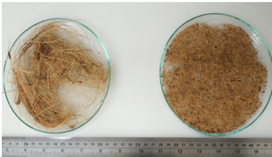
Figura 2 – Fibras de coco antes (esquerda) e após (direita) processamento em moinho de facas no laboratório Fonte: Autor, 2019.
