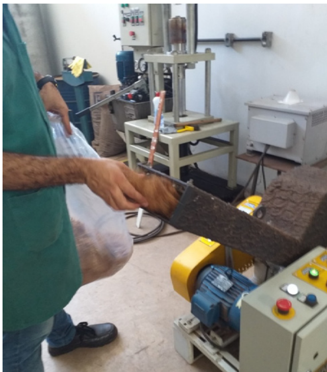
Figura 1 - Inserindo a fibra de coco na entrada do moinho de facas Fonte: Autor, 2019.
