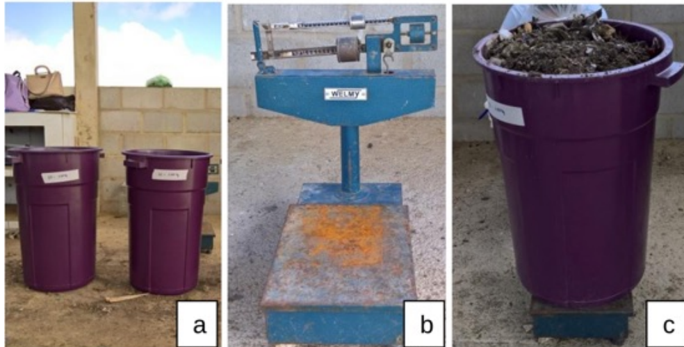
Figura 7 - (a) Identificação dos recipientes; (b) balança utilizada para pesagem dos resíduos; (c) pesagem dos materiais. Fonte: Autores (2018).
