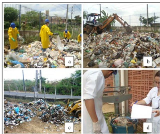
Figura 3 - a: abertura das sacolas; b: homogeneização; c: quarteamento; d: pesagem para enchimento da célula experimental. Fonte: Araújo Neto (2016).
