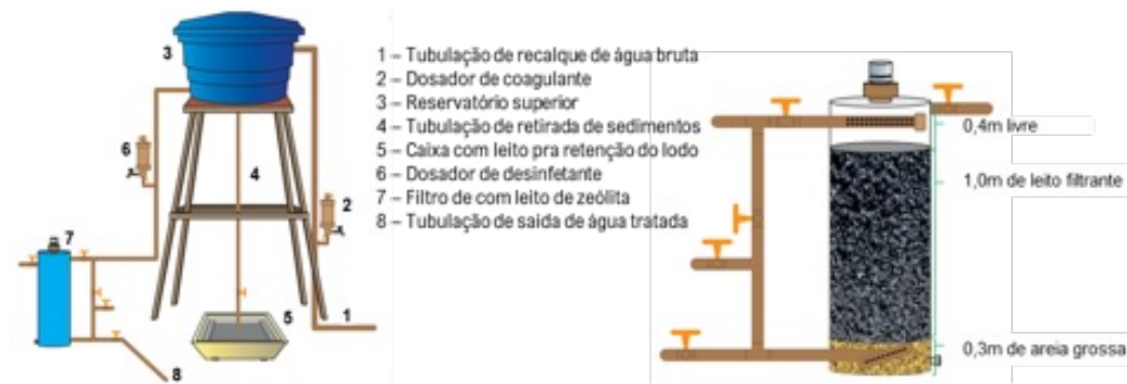
Figura 1 - Ilustração da SALTA-z em escala real e detalhamento do filtro
